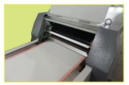
采用超强的抽風冷却系統,讓粘合后 的布料在短时間内緩和定型, 保證粘 合質量。
