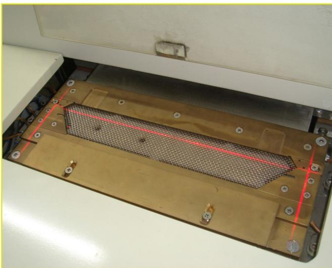
CF-8183 鐳射燈精確定位 Laser light for positioning
